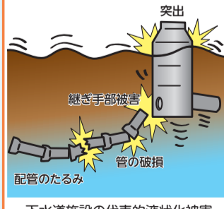
下水道施設の代表的液状化被害
