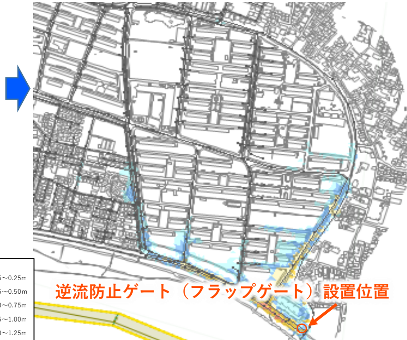
樋管操作+河道掘削+逆流防止ゲートによる 浸水被害軽減シミュレーション結果
