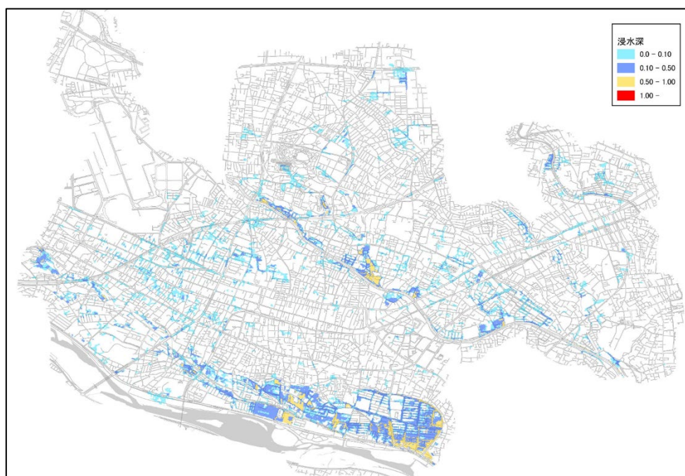
図 6-6 最終段階の対策前浸水状況（計画降雨 L1）
