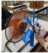
キットで大きな風車を作り、風の力で回して、LED電球に明かりが灯るかの実験です。ギヤ比を変えたり、羽根の枚数を変えてみたりしました。
